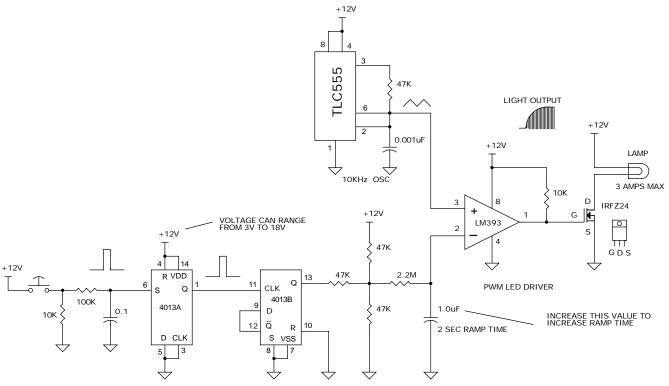
OUTPUT TOGGLES ON/OFF WITH EACH PUSHBUTTON ACTIVATION
