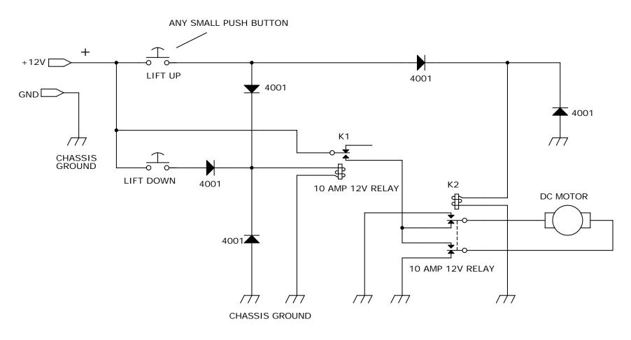
LIFT UP BUTTON SPINS MOTOR ONE DIRECTION
