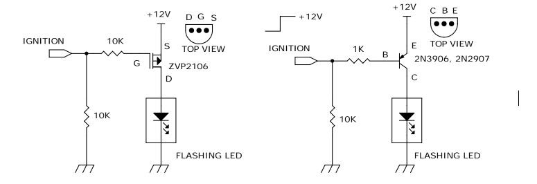
FLASHING LED TURNS OFF WHEN THE IGNITION SWITCH IS ON
