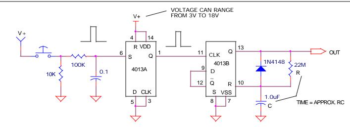
OUTPUT TOGGLES ON/OFF WITH EACH PUSHBUTTON ACTIVATION
