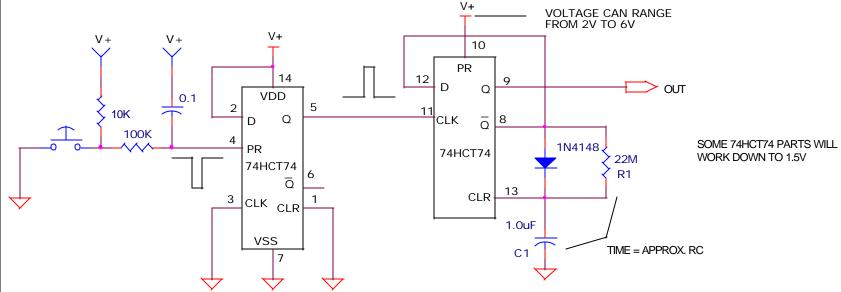
OUTPUT TOGGLES ON/OFF WITH EACH PUSHBUTTON ACTIVATION
